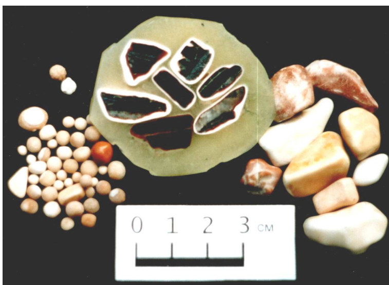
Рис. 1. Форма “перлів” різного розміру і їх внутрішня будова. В центрі – полірований зріз декількох “перлів”, який демонструє їх зональну будову.
